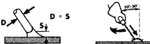
Після виконання зварного шва поверніть електрод назад. Це необхідно зробити для заповнення зварювального кратера.
