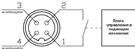
Используется только контакты 1 и 2, которые замыкаются в нужный момент времени. Когда источник должен работать, контакты замкнуть, когда источник должен быть выключен – разомкнуть.
