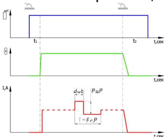
Порядок изменения значения параметра функции смотрите в п.6.1. Время предпродувки ( $t_1$ ) и послепродувки ( $t_2$ ) защитным газом задается на механизме подачи проволоки.
